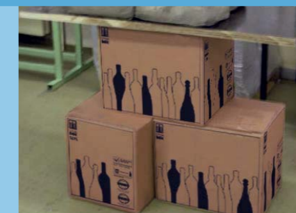
Stapelprüfung unter statischer Last, DIN-EN 2234
