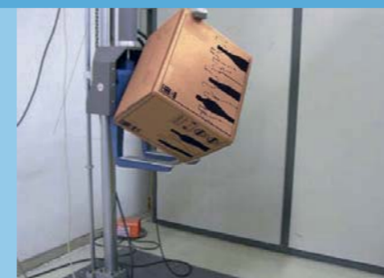
Vertikale Stoßprüfung (freier Fall), DIN-EN 22248
